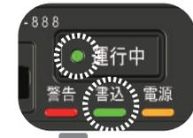
※必ず「運行中」ボタンと「書込」ランプが消灯しているのを確認してエンジン OFF にしてください。
